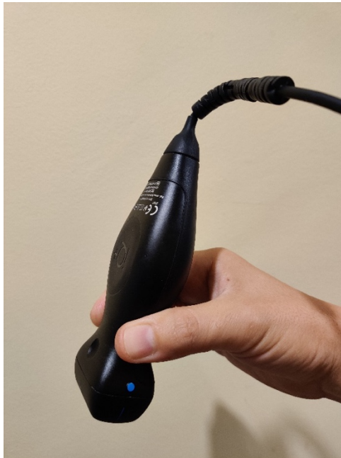
ILUSTRACIÓN 1: FORMA IDÓNEA DE SUJETAR LA SONDA PARA MAXIMIZAR LA PRECISIÓN DE MOVIMIENTOS
